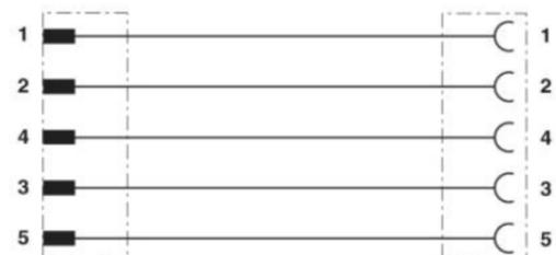
Kontaktbelegung des M12-Steckers und der M12-Buchse
