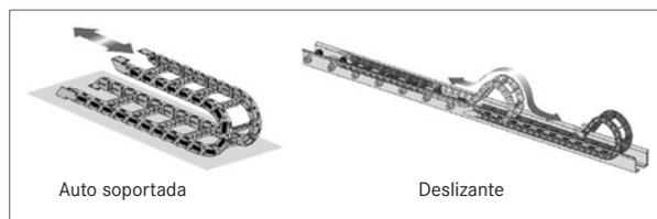
9. Con cadenas deslizantes se recomienda que el cable sólo se fije en el punto en movimiento. Debe tenerse en cuenta una pequeña reserva de cable en el punto fijo. (Tenga en cuenta las instrucciones de montaje del fabricante de cadenas).
